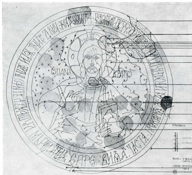
Fig. 1. Relevul Pantocratorului din turla naosului cu prezentarea punctelor de prelevare.
