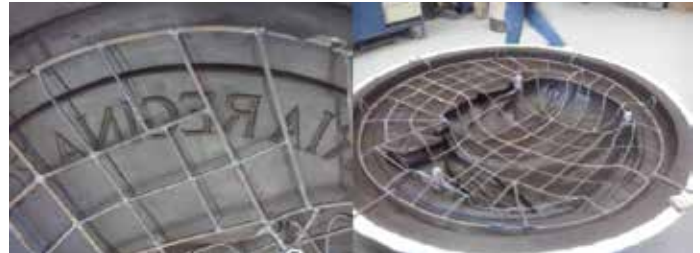
Fig. 13 Efigiile Regale Etapa V/2015, imagini înainte de turnare. Cele două efigii din bronz demontate de pe arc, realizându-se matrițe pentru turnarea în similiplată de sculptor – restaurator Alexandru Siminic. (Credo Design, 2015)
